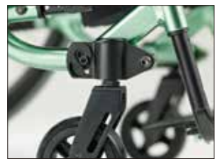
幅広い調整範囲に対応する「キャスト角度調整システム」
