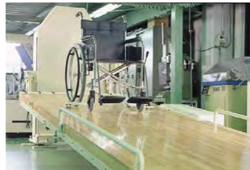
床面傾斜可動試験機 直進走行性試験 / 静止力試験 / 静的安定性試験
