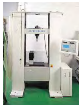
強度検査 社内規格(SG認定工場取得基準)にて、確認テストを実施しています。
