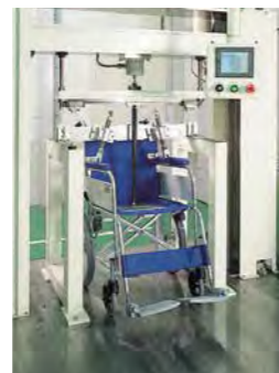
静的動的負荷総合試験機 アームサポート試験 / 座圧試験
