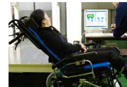
体圧分散測定 体圧の分布を計って、よりシーティングに優れたシート形状を研究しています。
