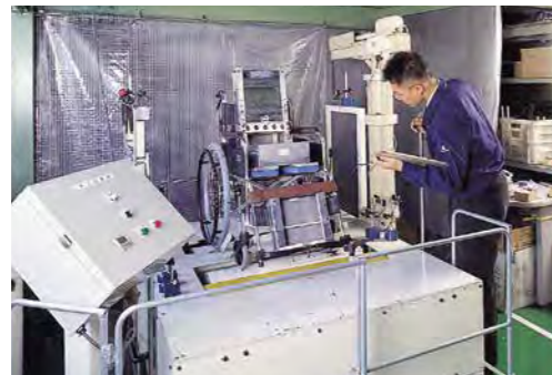
走行耐久性試験 JIS走行耐久性試験(20万回100kg荷重ダブルローラーテストクリア)にて確認テストを実施しています。
