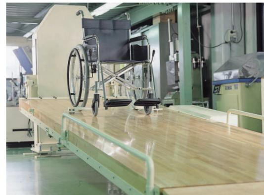
**床面傾斜可動試験機**
